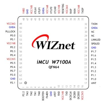
Fig 2. W7100A 64pin QFN package
